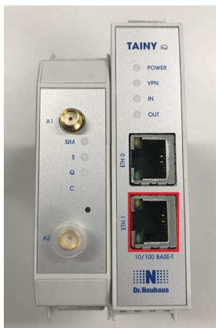
Die LTE-Antenne wird an den vorgesehenen Antennen-Port A1 angeschlossen.
