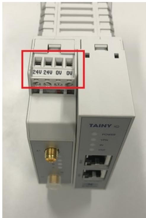
Bevor das Gerät eingeschaltet wird, sollten das Netzkabel zur FWA sowie die LTE-Antenne angeschlossen sein. Sobald das Gerät die Startphase beendet hat (ca. 3 Minuten), wird der vorparametrierte VPN-Tunnel zum NB automatisch aufgebaut.
