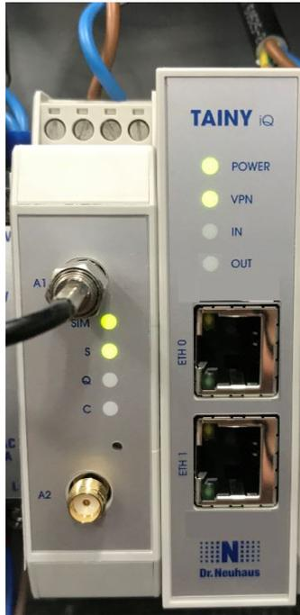
Sollten die VPN-LEDs nicht durchgängig leuchten, kann das ggf. an einer schwachen Signalstärke des Mobilfunkanbieters liegen. Es sollte geprüft werden, ob die Position der LTE-Antenne verändert werden kann. Die Antenne ist fachgerecht und abbruchsicher an der Anlage zu installieren.
