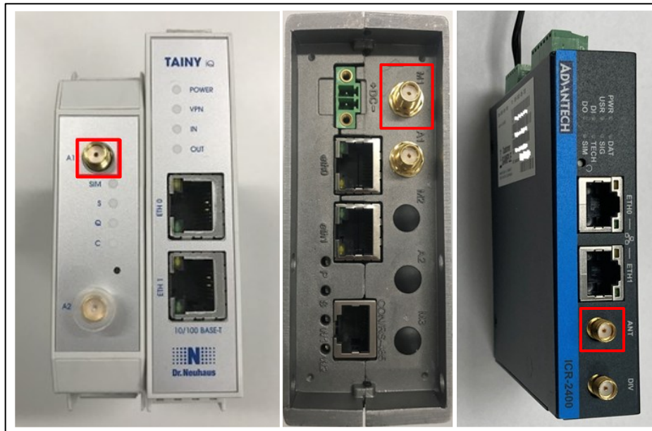
Abbildung 5 Antennenbelegung der Router-Varianten "TAINY" (links), "Garderos" (mitte), „ADVANTECH“ (rechts)
