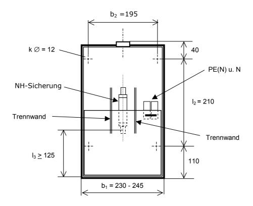
Maße  $b_1$ ,  $b_2$ , k,  $l_2$ ,  $l_3$  in mm nach DIN 43 627, Tiefe des KH 00 A = 130 mm
